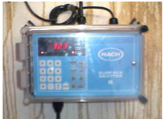
**Afficheur du turbidimètre**
